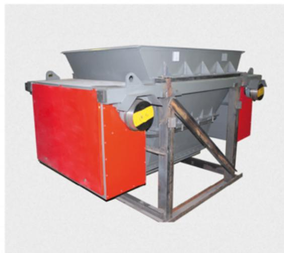
Бетоновозная телега СМЖ-2В/2М (бункер раздаточный) предназначена для передачи бетонной смеси удобоукладываемостью не более 8 см. от бетоносмесителей до бетоноукладчиков на формовочных постах.
